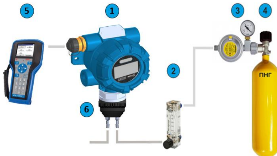
Рисунок 63– Комплект для калибровки нуля с помощью HART-коммуникатора
