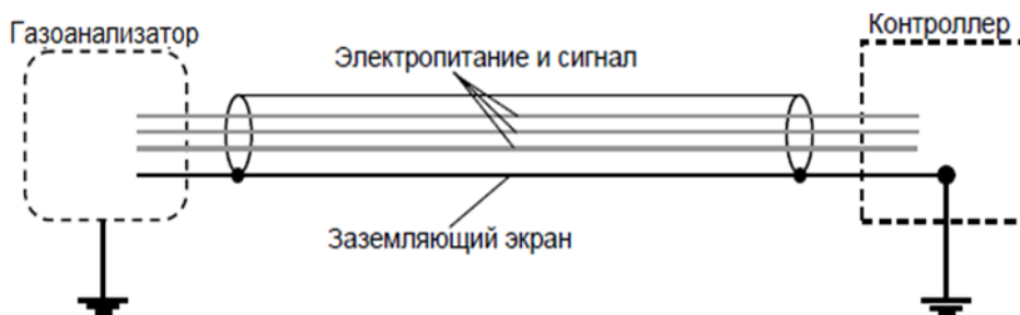
Рисунок 30 – Заземление экранированного кабеля
